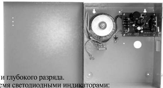
БПР-3 защищен от перегрузок; аккумулятор защищен от перезаряда и глубокого разряда.
