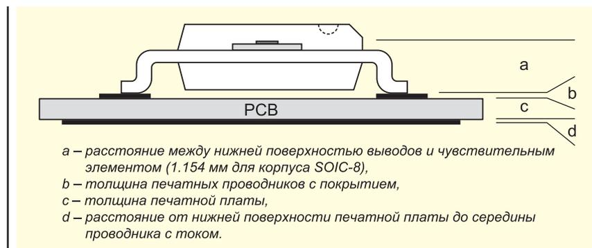
**Рисунок 3** Проводник с током и микросхема AA002-2 по разным сторонам печатной платы
